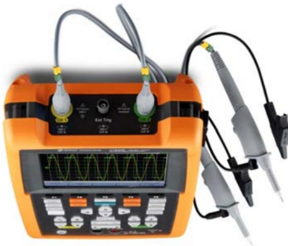
将测试引线连接到万用表端子
