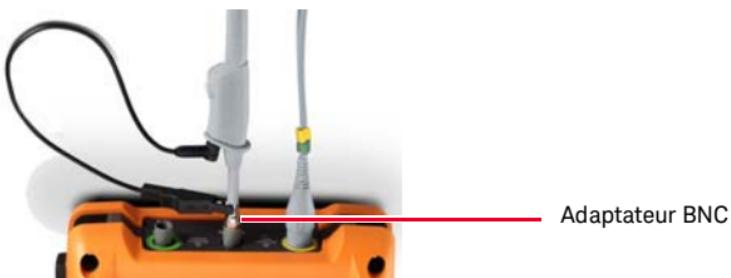
Utilisez un outil non métallique pour régler le condensateur ajustable sur la sonde et obtenir l'impulsion la plus plate possible.
