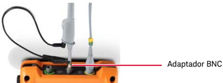
Use uma ferramenta não metálica para ajustar o capacitor variável na ponta de prova e obter um pulso o mais plano possível.
