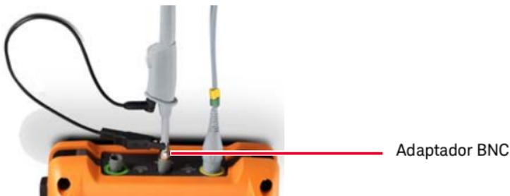
Utilice una herramienta no metálica para ajustar el condensador en la sonda para el pulso más plano posible.
