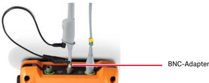
Stellen Sie den Trimmkondensator des Tastkopfes mit einem nichtmetallischen Werkzeug auf den flachestmöglichen Impuls ein.
