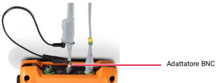
Utilizzare uno attrezzo non metallico per regolare il condensatore di compensazione sull'impulso più piatto possibile.
