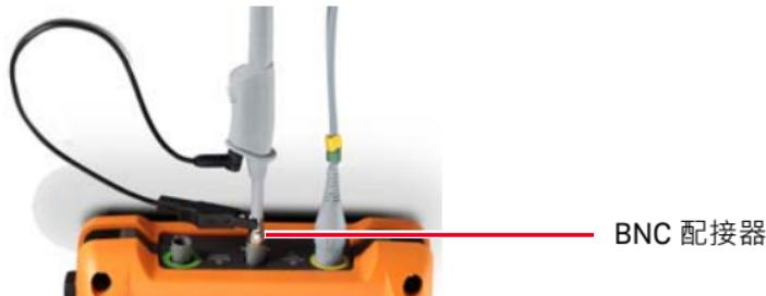
使用非金屬工具調整探頭上的修整電容，使脈波盡可能平坦。
